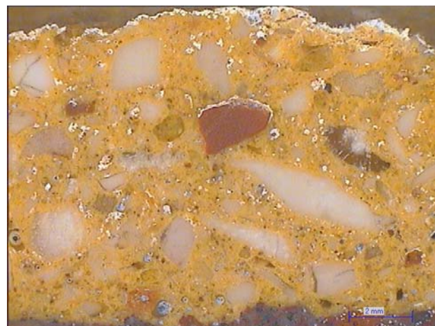
Fig. 16. Sezione del Campione 4 - 2° strato. (20.0 X)
