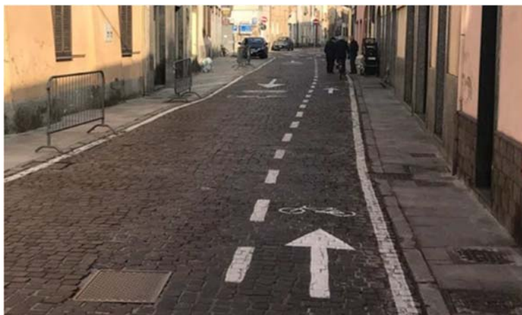
Fig. 29.13 Esempio di corsia per doppio senso ciclabile
