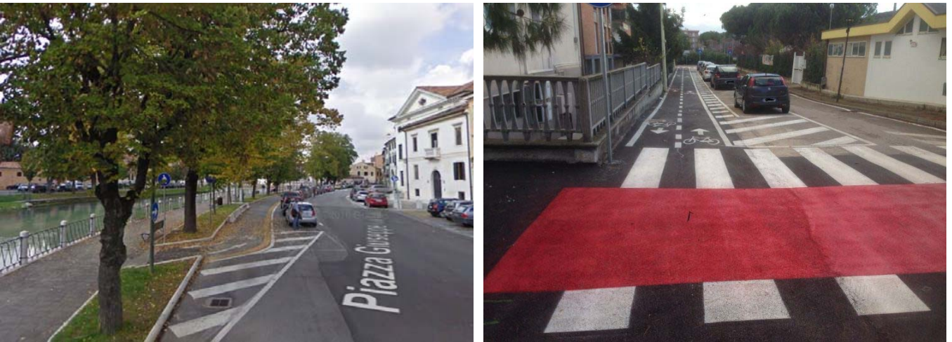
Fig. 29.4 Esempi di pista ciclabile in sede propria bidirezionale separata da fascia di sosta
