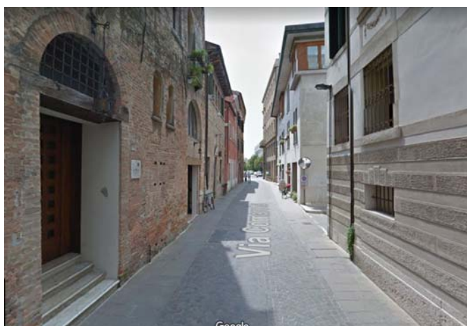
Fig. 27.1 Esempio di utilizzo della pavimentazione differenziata all'interno di ZTL per accennare gli spazi pedonali in assenza di segnaletica (Treviso via Roggia)
