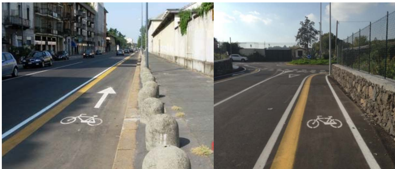
Figg. 29.7 Esempi di pista ciclabile con corsia riservata in senso concorde alla attigua corsia veicolare
