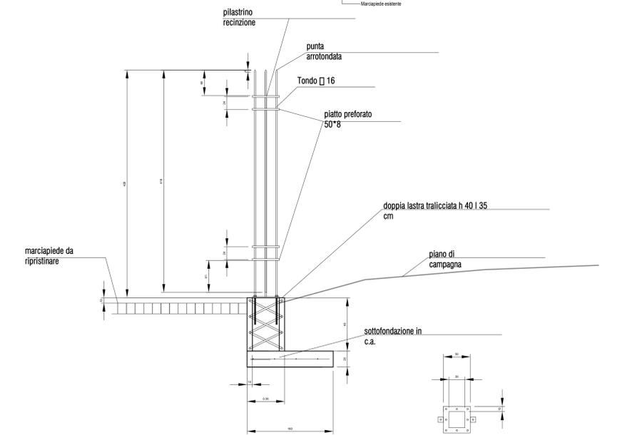
PARTICOLARE SEZIONE SU PILASTRO
